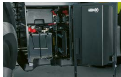
Na desnoj strani uspona lako su dostupni baterija i pretinac za alat.
