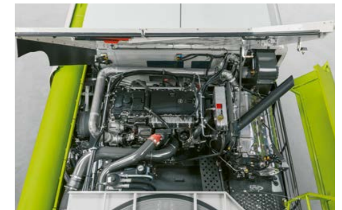
Mercedes-Benz OM 470 con 300 kW / 408 CV para LEXION 6700
