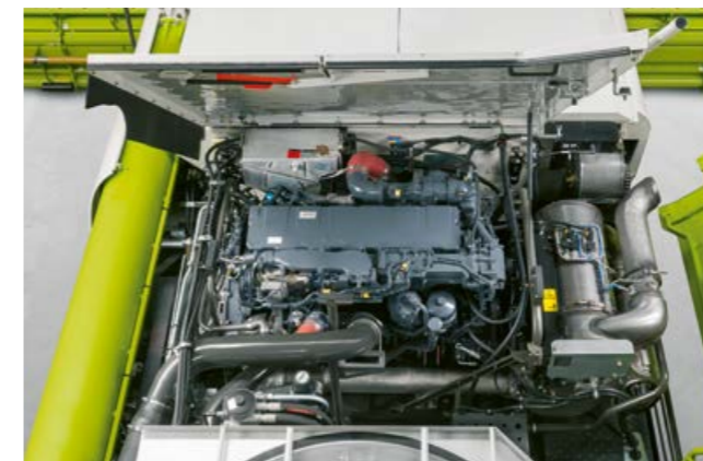
MAN D 26 con 373 kW / 507 CV para LEXION 6900
