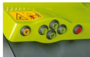
Zunanji upravljalni elementi za zadnje hidravlično dvigalo, priključno gred in izbirni krmilni ventil (samo CEBIS).
