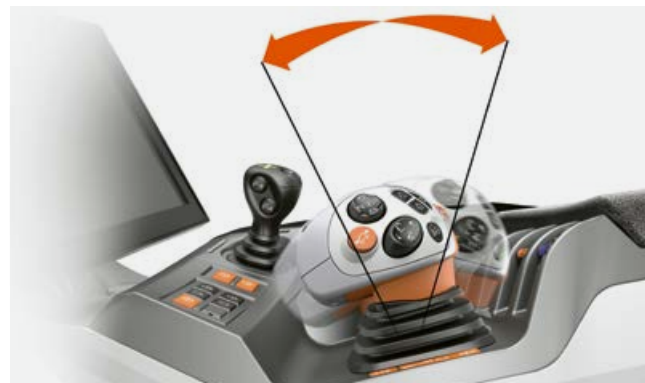
Progresivno upravljanje s tehnologijo brezstopenjskega menjalnika CMATIC.
