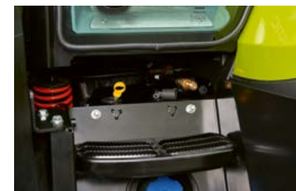
Levo na stopnicah najdete priključek za stisnjen zrak.
