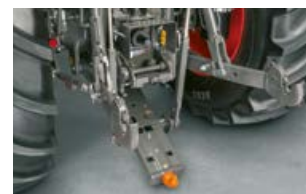
Poleg priklopnega bloka je na voljo kavljasta vlečna sklopka.
