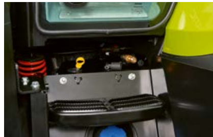
Do lado esquerdo na entrada, existe uma alimentação de ar comprimido.
