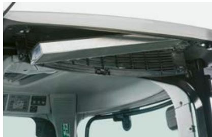
Acesso mais simples ao filtro de ar da cabina no tejadilho da cabina
