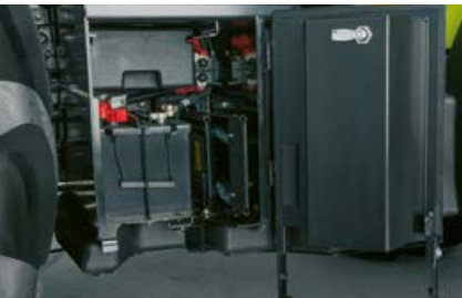
Do lado direito, na entrada, a bateria está muito acessível, bem como um compartimento para ferramentas.
