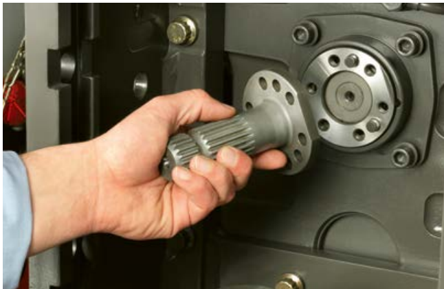
Mudança simples das pontas do veio de tomada de força
