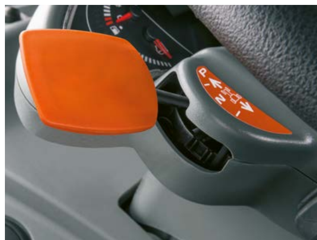
Inversore REVERSHIFT disponibile con freno di stazionamento elettronico
