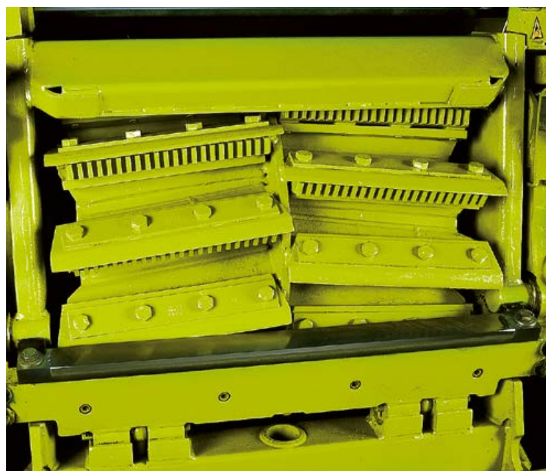
Micro-listoncillos debajo de las cuchillas para un acondicionado adicional del material de cosecha
