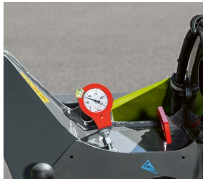
▲ Z ACTIVE FLOAT kosilnica kar drsi čez podlago. Nastavljena vrednost na manometru je dobro vidna iz kabine.
