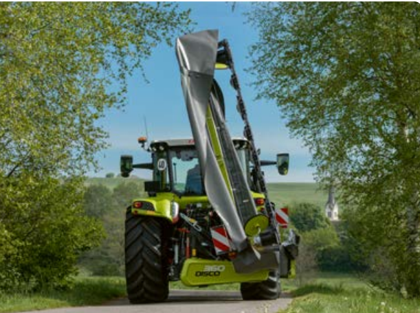
▲ Majhna transportna širina in prost pogled nazaj: V 105-stopinjskem transportnem položaju ste s kosilnico DISCO 100 varni na cesti. ▼ Sila deluje na težišče: Osrednja razbremenilna vzmet optimalno prenaša prednosti sredinskega vpetja na stransko vpete zadnje kosilnice.
