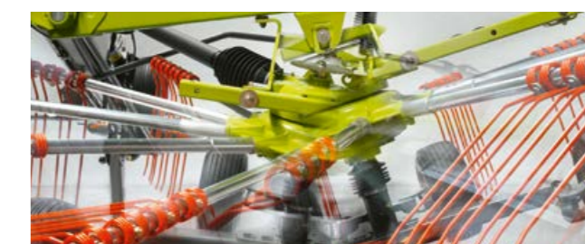
Kardansko vpetje rotorja: Rotorji se prilagajo tlom – ne glede na tip traktorja.
