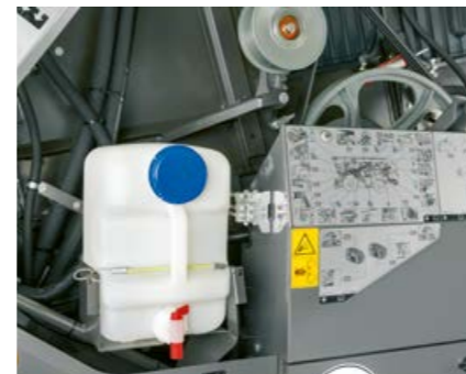
Viegla piekļuve eļļošanas sadales blokiem
