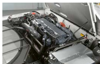
TRION 760 un 750 darbina efektīvs sešcilindru MAN dzinējs ar jaudu līdz 507 ZS un 12,4 litru tilpumu.
