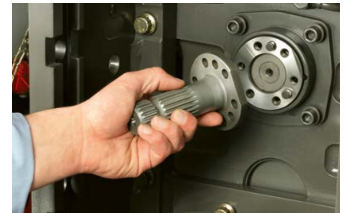
Einfacher Wechsel der Zapfwellenstummel
