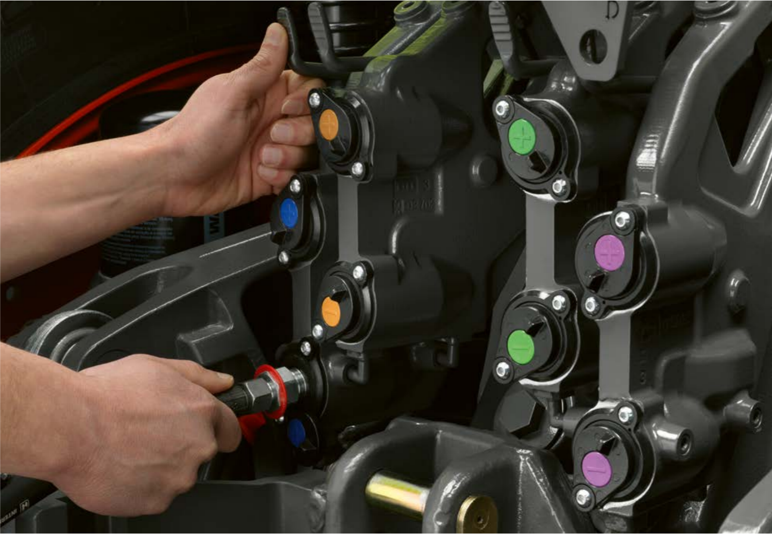
Am Frontkraftheber befinden sich Anschlüsse für ein Steuergerät und einen freien Rücklauf.
