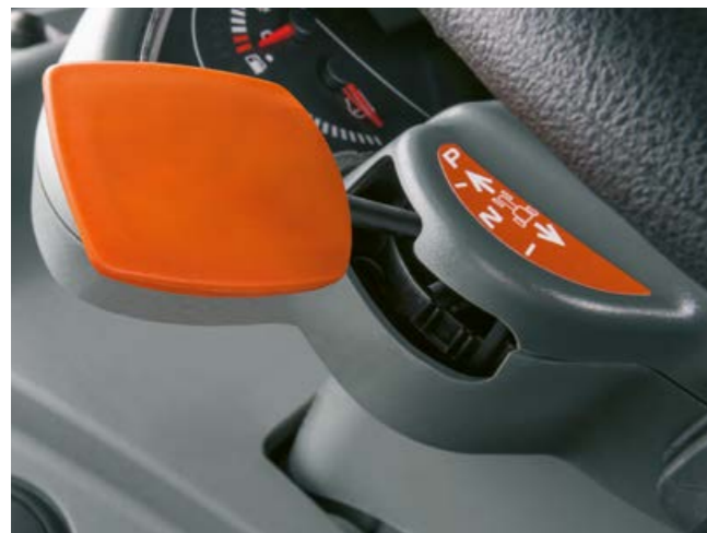
REVERSHIFT Wendeschalthebel mit elektronischer Feststellbremse verfügbar
