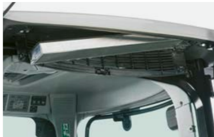
Leichter Zugang zum Kabinenluftfilter am Kabinendach
