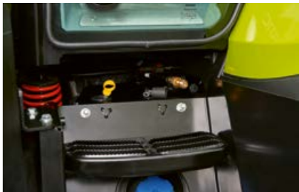
Links im Aufstieg befindet sich ein Druckluftanschluss.
