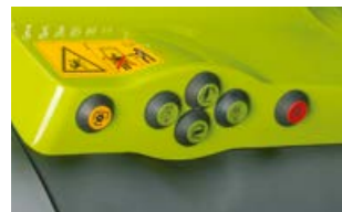
Externe Bedienelemente für den Heckkraftheber, die Zapfwelle und ein wählbares Steuergerät (nur CEBIS)
