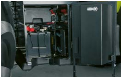
Rechts im Aufstieg befinden sich gut zugänglich die Batterie sowie ein Staufach für Werkzeug.
