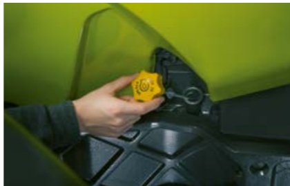
Ölstandskontrolle und Nachfüllen bei geschlossener Haube möglich
