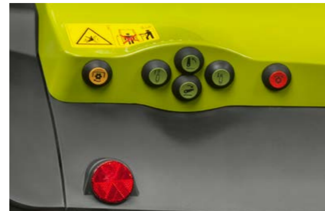
Externe Bedienung für Heckzapfwelle
