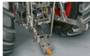
Alternativ zum Anhängelock ist eine Hitchhakenkupplung verfügbar.
