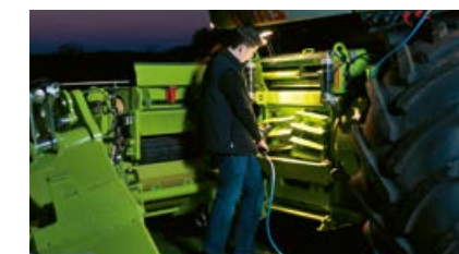
QUICK ACCESS dělá kontrolu řezacího ústrojí během několika minut.
