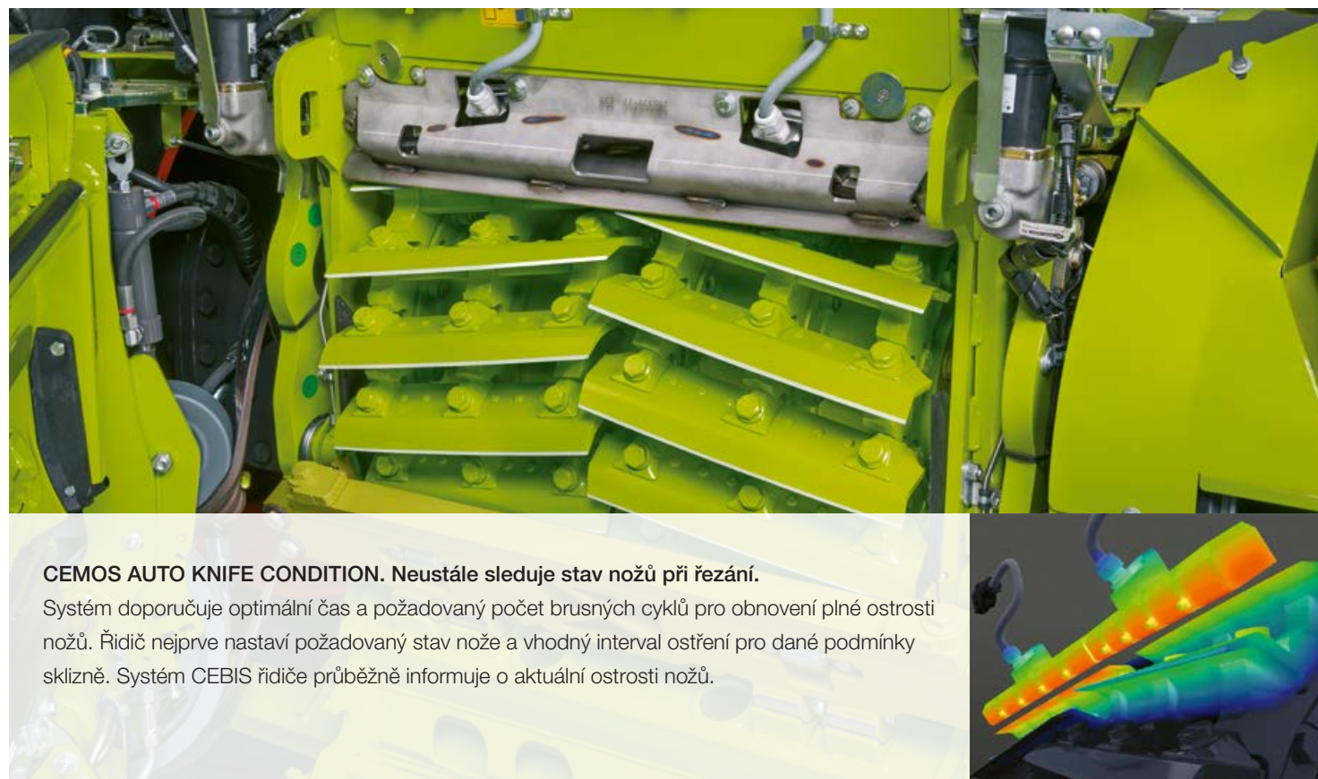
Detekce stavu nože pomocí indukce magnetického pole
