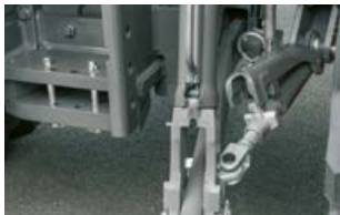
Stabilisateurs automatiques disponibles pour les deux bras de relevage
