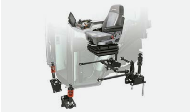
Suspension de la cabine en quatre points.
