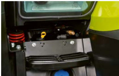
Une prise d'air comprimé est présente au-dessus du marchepied d'accès à la cabine côté gauche.
