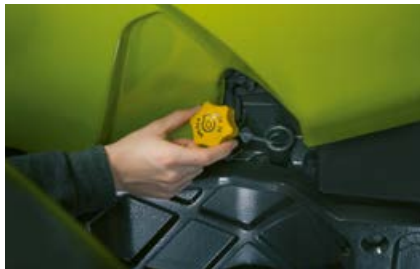
Le contrôle et l'appoint du niveau d'huile peuvent se faire capot fermé.
