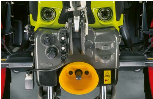
Les coupleurs sur le relevage avant permettent de brancher un distributeur et un retour libre.
