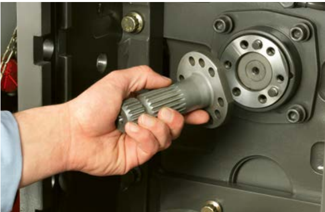
Embout de prise de force facilement interchangeable
