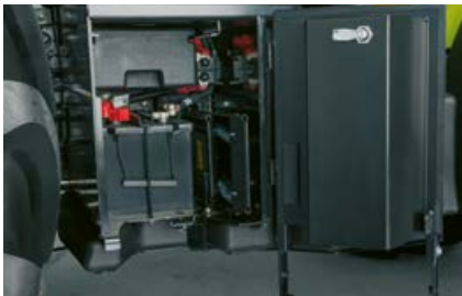
La batterie et la boîte à outils sont aisément accessibles au niveau du marchepied droit.
