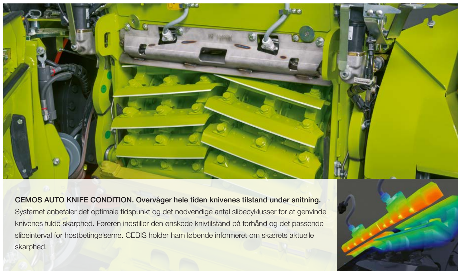
Registrering af knivstatus via magnetisk feltinduktion
