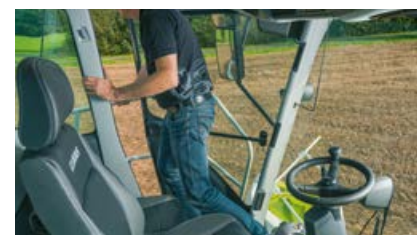
Sædekontakten kobler automatisk frontudstyret og hovedtrækket fra.
