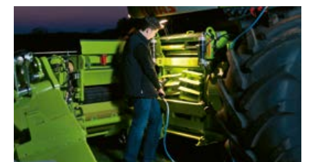
QUICK ACCESS giver mulighed for inspektion af snitteraggregaterne på få minutter.
