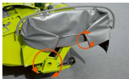
Lågt placerad vridpunkt gör att DISCO följer marken exakt.
