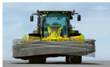
Pendelupphängning kompenserar för ojämnheter tvärs mot körriktningen.
