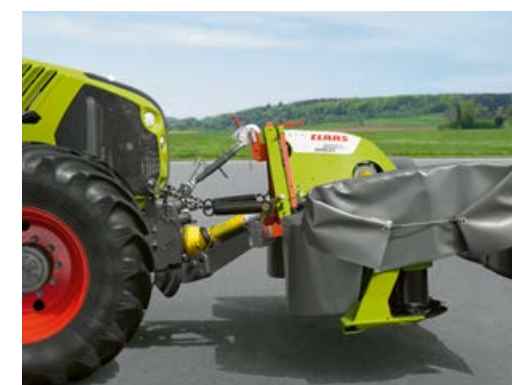
Beroende på utrustning har slåttermaskinen avlastning via en justerbar fjäder eller ACTIVE FLOAT.
