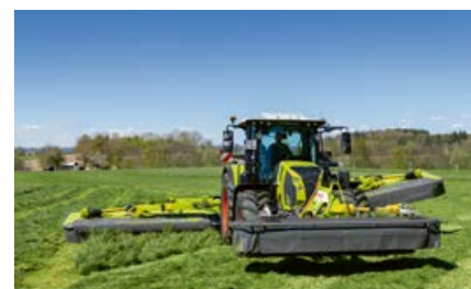
Kompakt upphängning ger hög markfrigång på vändtegen.
