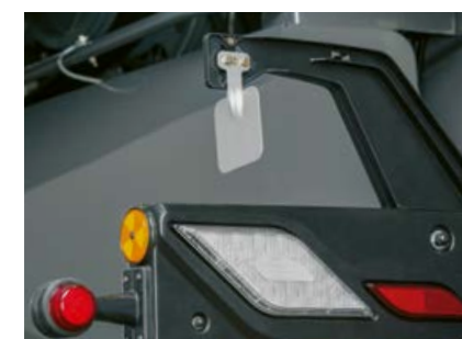
Sensor for automatisk tilpasning af kasteretningen
