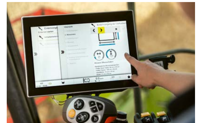
Indtastning af målene i den forhåndenværende spildskål i CEBIS
