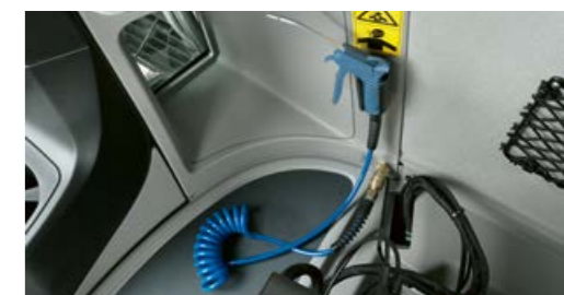
För snabb städning ute i fält – uttag för tryckluft och spiralslang med pistolventil.
