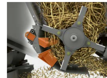
Motknivar och svängbar ledplåt i SPECIAL CUT.
