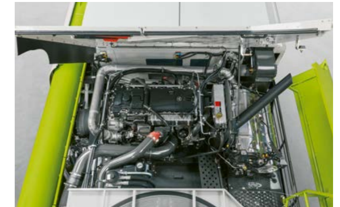
Mercedes-Benz OM 470 – 300 kW / 408 hk för LEXION 6700.
