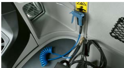
Soufflette dans la cabine pour un nettoyage rapide de l'espace intérieur entre deux chantiers
