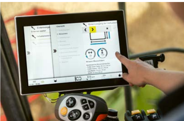
Enregistrement des dimensions du bac de calibrage sur le CEBIS
