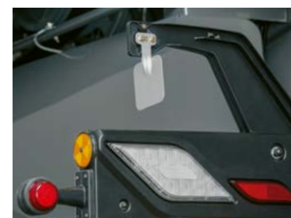
Sensor der automatischen Wurfrichtungsanpassung
