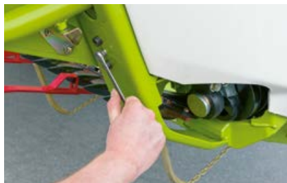
使用折叠式扳手可以轻松调节分禾器的高度。
