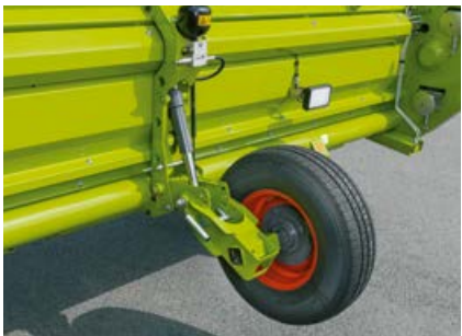
两个结实耐用的稳定轮可更好地适应地面
