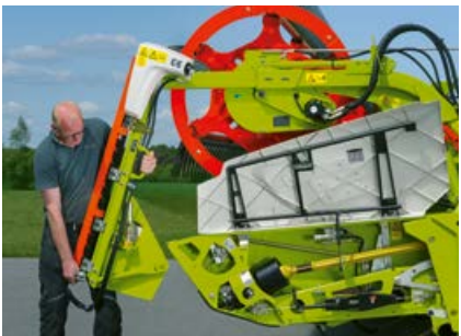
即插即用，进行油菜籽收割。 无需工具，只需几分钟即可完成液压驱动型油菜籽立刀的安装。油菜籽立刀安装完毕后，会自动激活喂入搅龙。割台由此便为油菜籽收割做好了准备。
