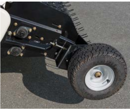
可通过导向轮调节作业深度。
