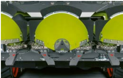
橡胶玉米棒抓取装置确保收割无损失。
