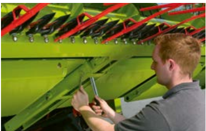
很容易触及用于底板调节的螺栓连接。
