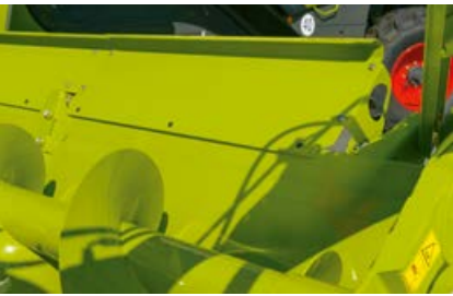
额外升高后壁，防止收割油菜籽时产生籽粒弹弹损失。
