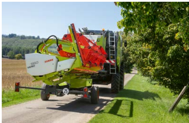
在安装有油菜籽立刀的情况下，也可以在道路上紧凑地运输VARIO割台。
