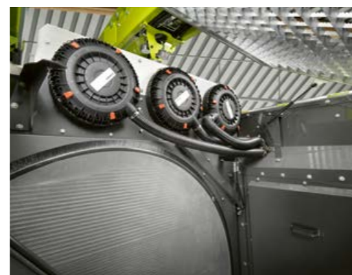
▲ Tris oro filtrus, kurie užtikrina patikimą oro tiekimą galingam varikliui, galima pasiekti be įrankių, kad būtų galima greitai atlikti techninę priežiūrą.
