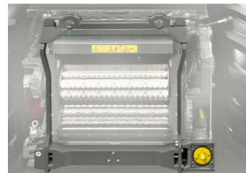
▲ Pakreipiamas rėmas užtikrina aktyvų (hidraulinį) arba pasyvų (plaukiojančioje padėtyje) valdomą šoninį kompensavimą, kad priekiniai priedai optimaliai kopijuotų lauko paviršių.
