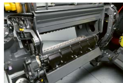
▲ Prieš atliekant techninės priežiūros darbus, pradinio suspaudimo volus galima pakelti hidrauliniu būdu.
