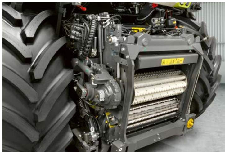
▲ Visiškai hidraulinis pradinis suspaudimas užtikrina didelį našumą dorojant bet kokių kultūrų derlių ir smulkinant bet kokio ilgio pjausniais bei garantuoja vienodą smulkinimo kokybę. 20 psl.
