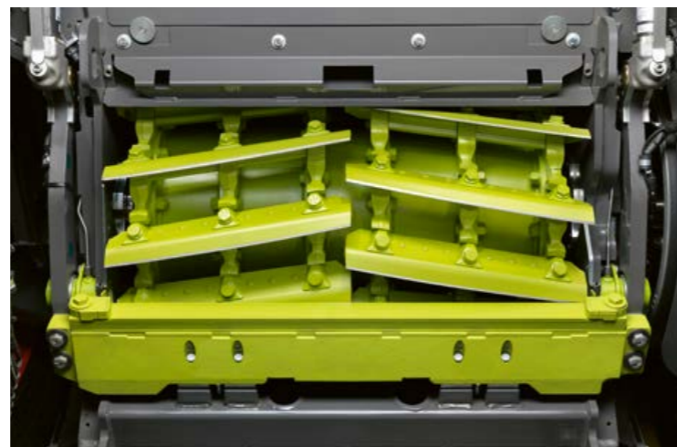
▲ 910 mm pločio V-FLEX smulkinimo būgnas pjauna lygiai ir tiksliai. Dėl daugybės konfigūracijų, šis smulkinimo būgnas gali būti pritaikytas patiems įvairiausiems poreikiams. 22 psl.
