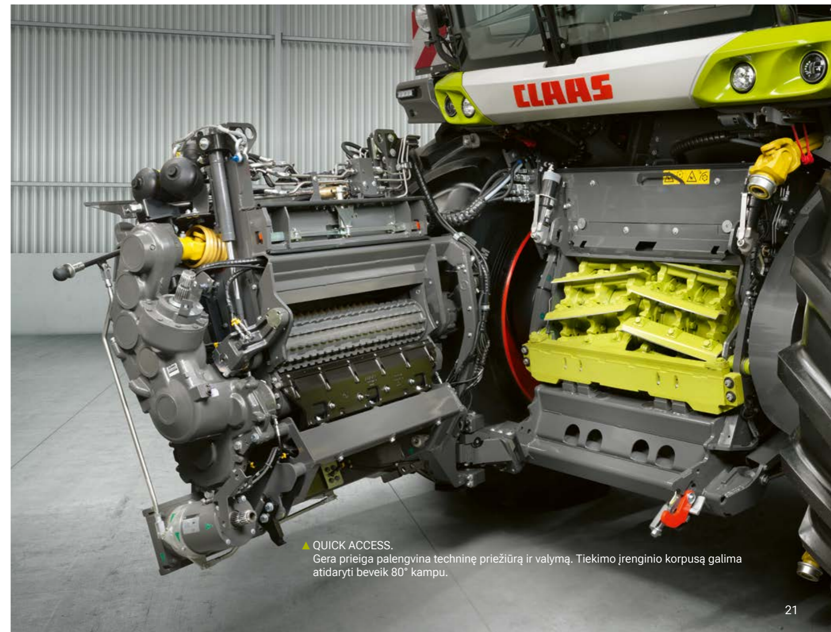
▲ Prieš atliekant techninės priežiūros darbus, pradinio suspaudimo volus galima pakelti hidrauliniu būdu.
