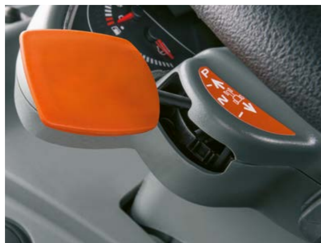
REVERSHIFT suunnanvaihto sähkökäyttöisellä pysäköintijarrulla saatavissa
