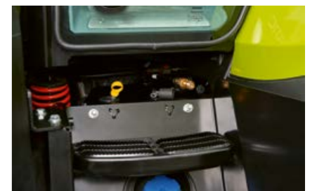
Vasemmalla, portaiden vieressä on paineilmaliitos.
