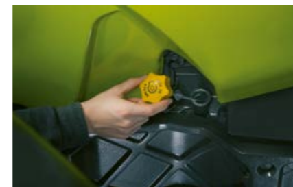
Moottoriöljyn määrän tarkistus ja lisäys voidaan tehdä peitto suljettuna
