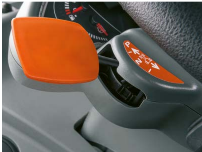
Mulighed for REVERSHIFT vendegearstang med elektronisk parkeringsbremse
