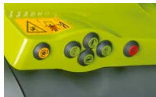
Eksterne betjeningslementer til baglift, PTO-aksel og et valgfrit olieudtag (kun CEBIS)
