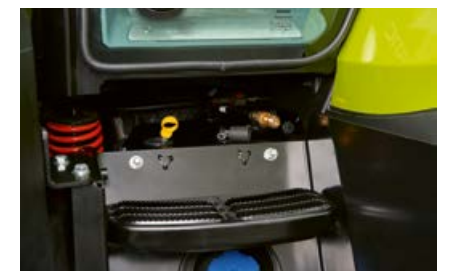
Der er monteret en tryklufttilslutning til venstre i stigen.
