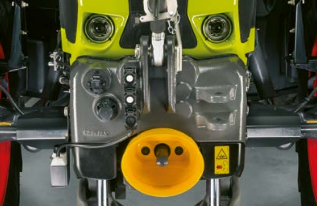
Frontliften er udstyret med tilslutninger til et olieudtag og et frit returløb.
