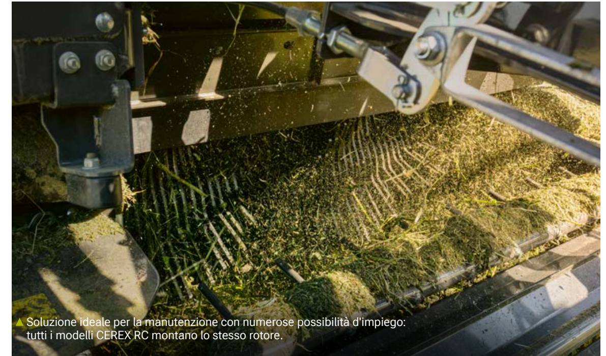
▲ Il fondo di taglio PRO apribile si adegua attivamente al flusso di prodotto.
