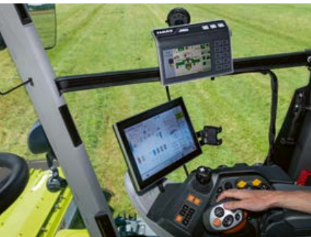
Facilità di comando, ad esempio, tramite diversi terminali compatibili ISOBUS o i tasti funzione ISOBUS sulla leva di guida.
