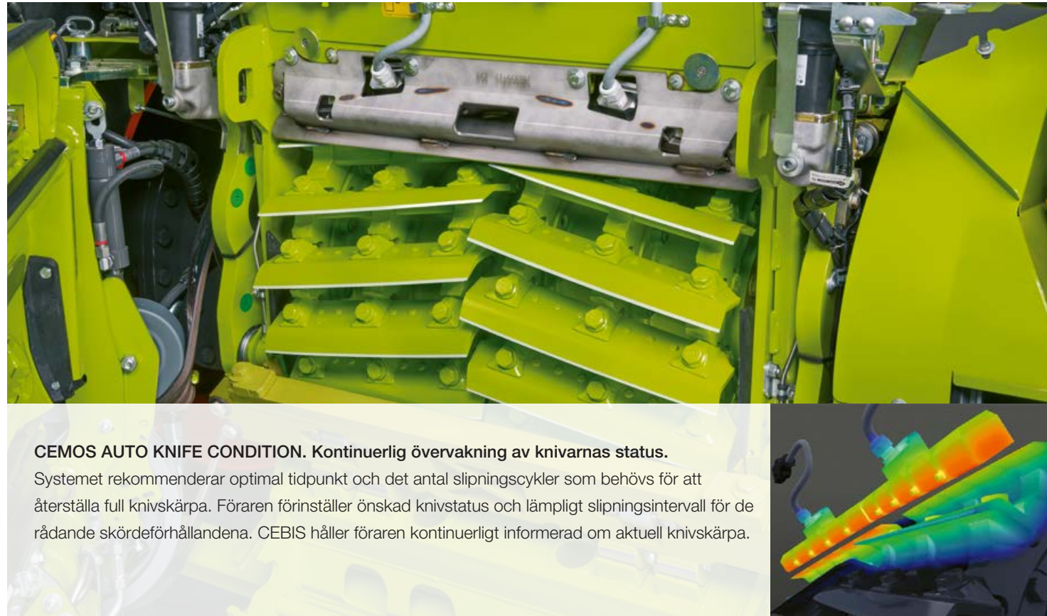
Status för knivarnas skärpa mätes med magnetfältinduktion.
