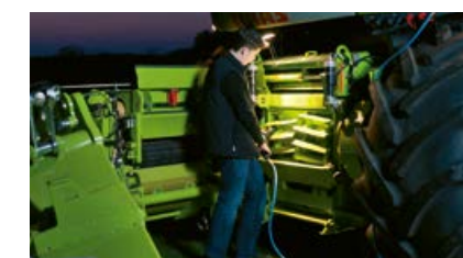
QUICK ACCESS gör inspektion av hackaggregatet möjlig på några minuter.
