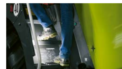
LED belysning på fotstegen ger säkerhet när man antrar/lämnar komforthytten.
