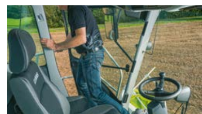
Säkerhetskontakt i förarsätet kopplar automatiskt ur frontaggregat och huvuddrivning.
