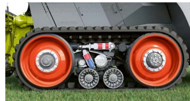
100 % kontaktyta: Löphjulet har full kontakt med marken.
