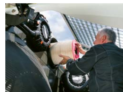
Výměna vzduchového filtru bez použití nářadí
