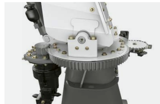
Robustní ozubený věnec je vhodný zejména pro sklizně ve svazích nebo při vysoké rychlosti
