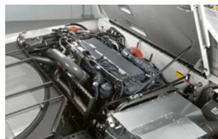
В моделите TRION 760 и 750 работят ефективни шестцилиндрови двигатели MAN с до 507 к.с. и работен обем 12,4 l.
