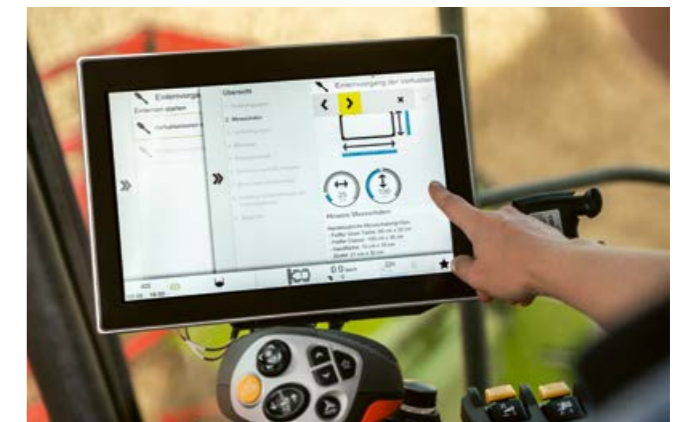
Въвеждане на измерванията на наличната тавичка за определяне на загубите в CEBIS
