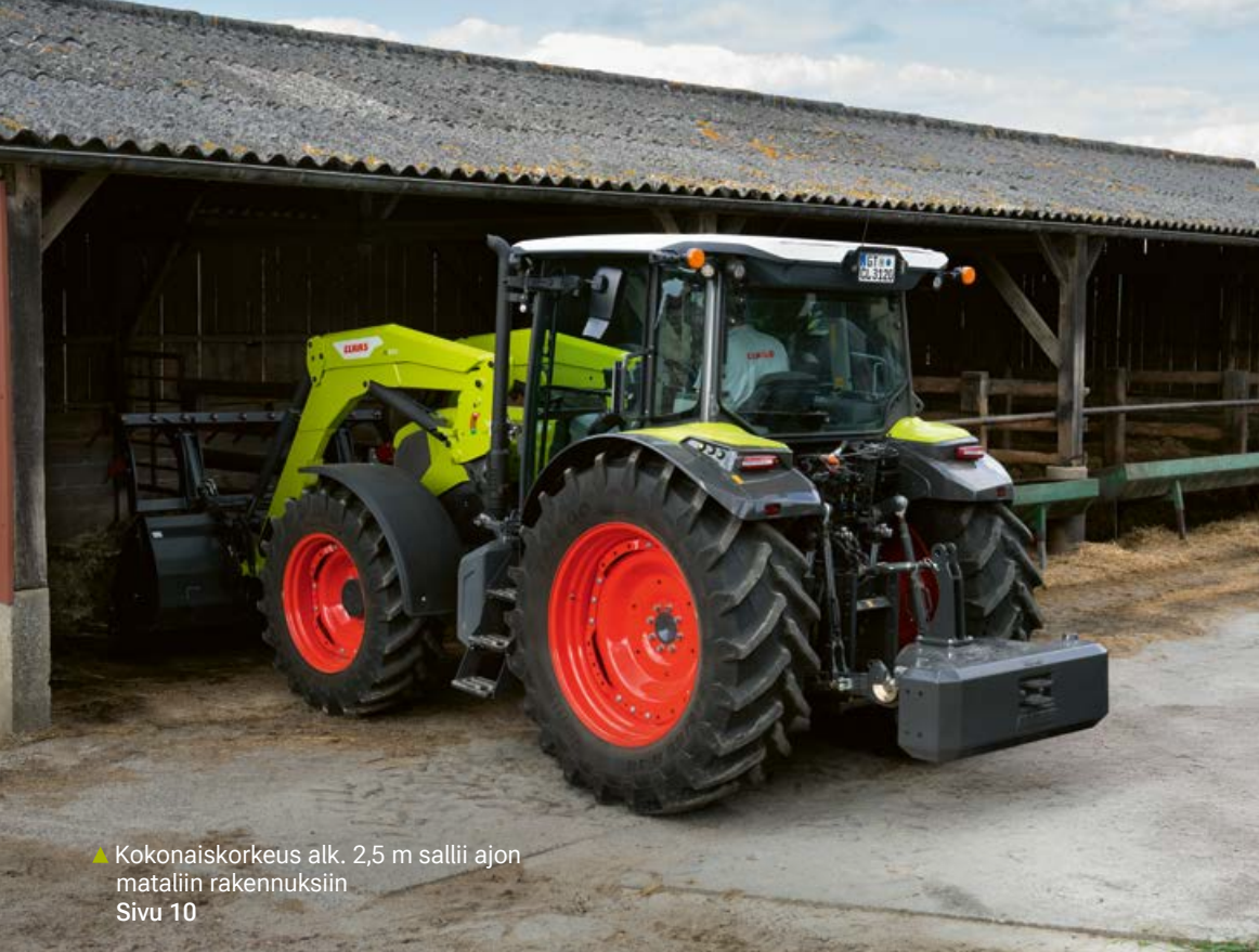
▼ Takanostolaitteen 5,3 tonnin enimm.nostovoima raskaita työkoneita varten Sivu 12
