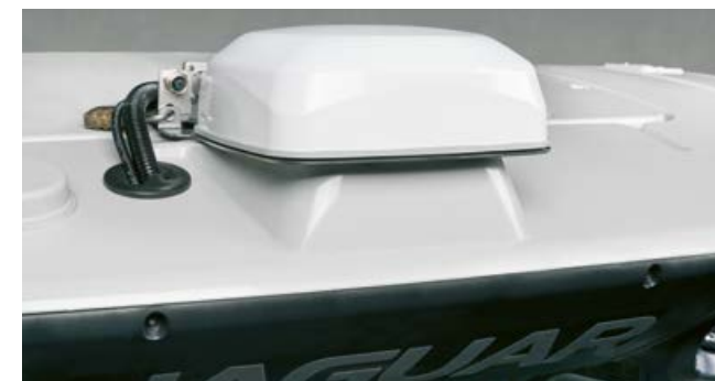
SAT 900 antenn och mottagare i samma enhet – med stölskydd.
