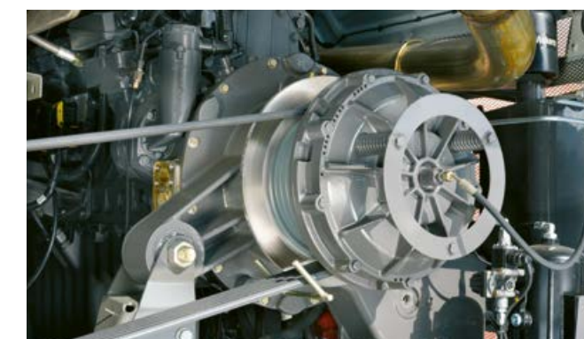
Hamulec przepływu materiału QUICK STOP
