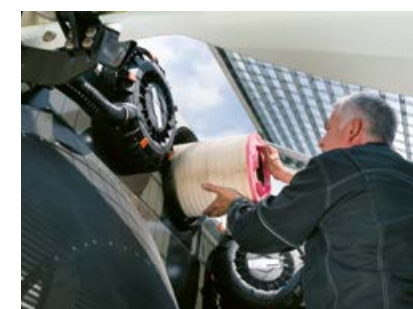
Wymiana filtra powietrza bez użycia narzędzi
