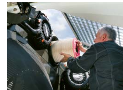
Udskiftning af luftfilter uden brug af værktøj
