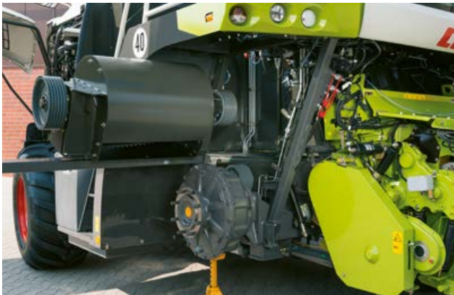
Simplicité pour le montage ou le démontage de l'accélérateur
