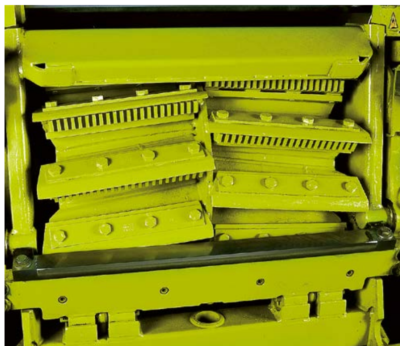
Barrettes sous les couteaux pour un conditionnement supplémentaire du fourrage
