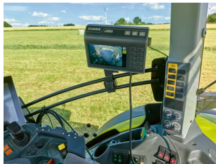
▲ Három különböző kezelési mód közül választhat: érintőfunkció, billentyűk vagy forgógombos kapcsoló.
