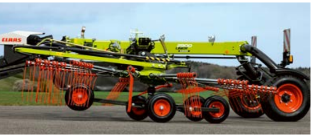
Efekt maza: rotor se pri dizanju ili spuštanju ponaša poput aviona pri uzlijetanju ili slijetanju.
