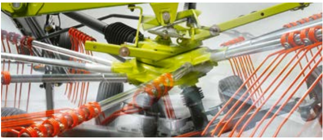
Kardanski ovjes rotora: Rotori se prilagođavaju tlu – neovisno o traktoru.
