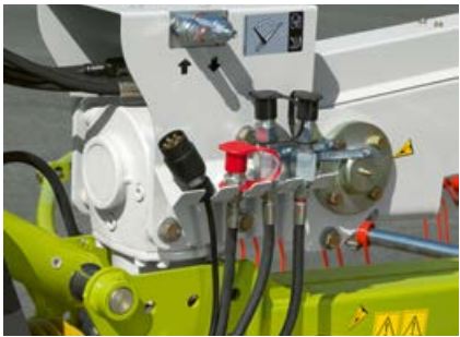
Hidraulička kontrola redoslijeda kao standard za vremenski pomak između prednjeg i stražnjeg rotora prilikom podizanja i spuštanja.
