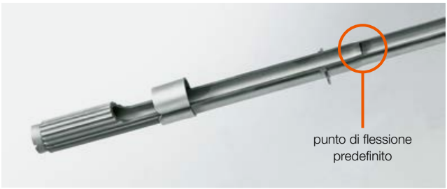
Ottima protezione: in caso di collisione i bracci si flettono in modo controllato in un punto predefinito.
