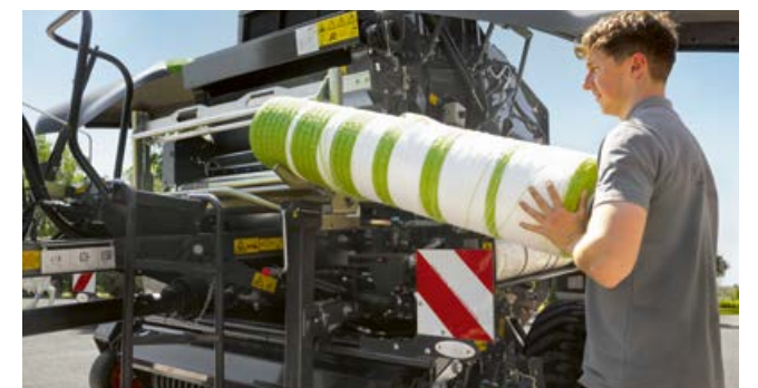
Nový systém vázání do sítě lisu VARIANT 500 je umístěn o 25 cm níže, aby se dala snadno čistit role sítě pod brzdou sítě.
