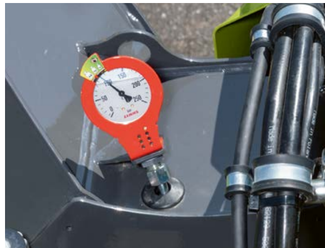
ACTIVE FLOAT'in avulla lautaspalkki liikuu pehmeästi pellon pinnalla.
