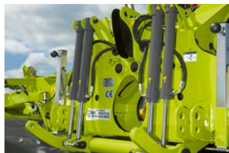
Løfte- og aflastningscylindrene, der er standard på ACTIVE FLOAT aflastningssystemet, sikrer et resultat, der er skånsomt mod græstorven.
