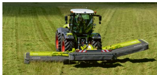
Enkelthævning af skårlæggerenhederne i forageren.
