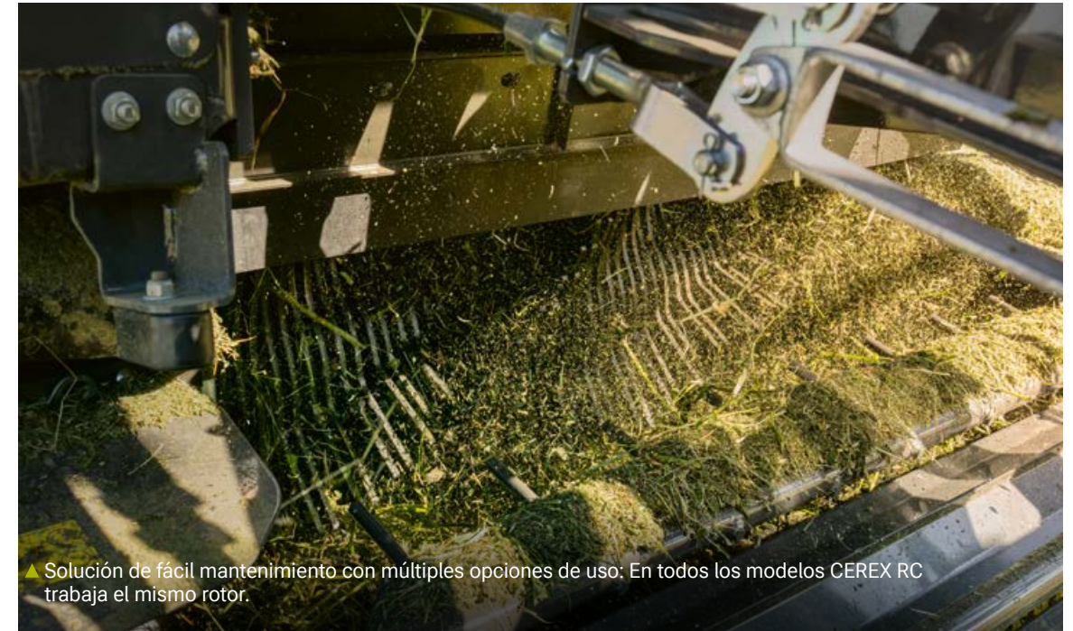
▲ El fondo de corte abatible PRO se adapta de forma activa al flujo de material.
