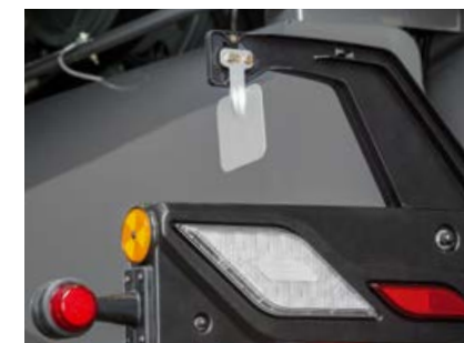
Czujnik automatycznego dopasowania kierunku rozrzutu
