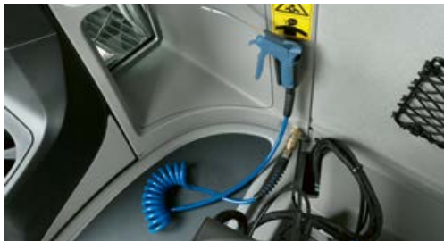
Pistolet pneumatyczny w kabinie umożliwia szybkie czyszczenie w międzyczasie
