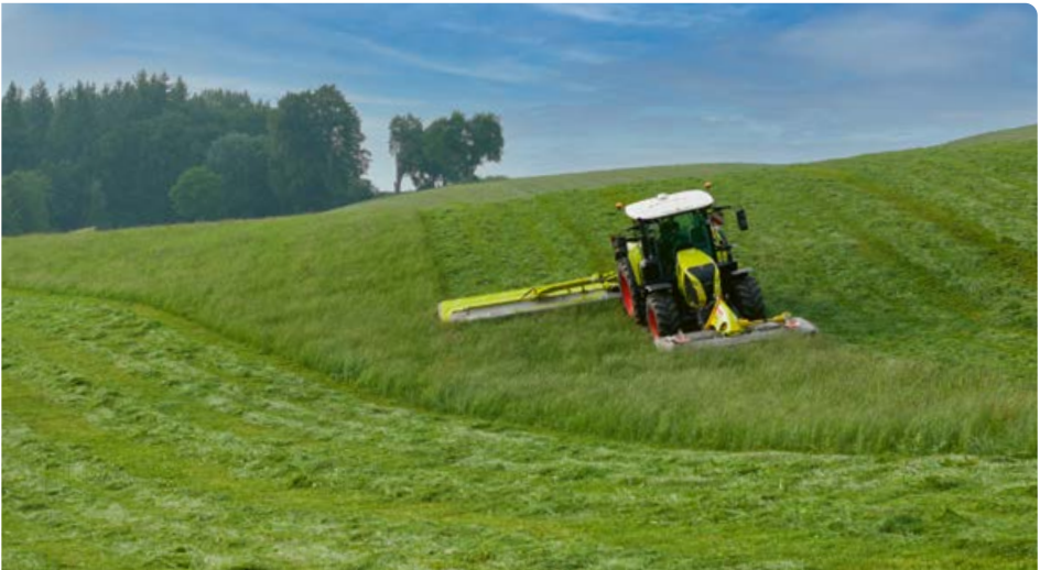
▼ Pellon pinnan seuranta - myös rinteissä. CONTOUR sarjan niittolaitteet pääsevät vapaasti heilumaan ja seuraavat tarkasti pellon pinnan muotoja.
