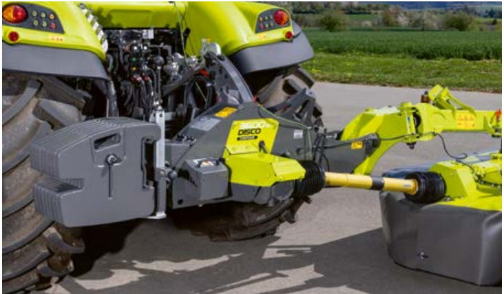
▼ Lisävarusteena saatavat vastapainot lisäävät vakautta, parantavat ajomukavuutta ja turvallista käyttöä mäkisessä maastossa.
