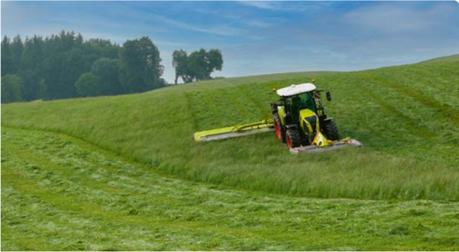
◀ Marktilpasning selv på hældninger. Skårlæggerne i CONTOUR serien pendler frit og følger markens konturer præcist.
