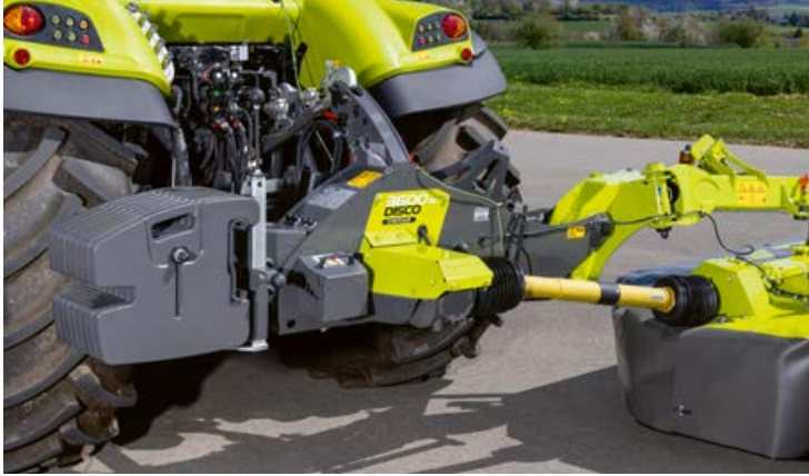
▼ Kontravægte som ekstraudstyr sikrer større stabilitet, højere kørekomfort og sikker drift i bakket terræn.
