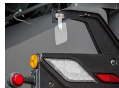
Senzor automatického přizpůsobení směru odhozu.
