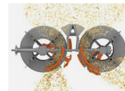
Radiální rozhazovač pro efektivní rozhození slámy při minimálním vynaložení síly.
