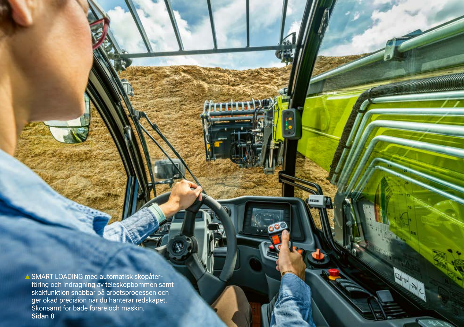
▼ Kraftfull hydrostatisk framdrivning – du kör steglöst från 0 till 40 km/h. Helautomatisk styrning av framdrivningen och logisk manövrering gör att du kan köra din SCORPION med känsla och precision i alla hastigheter. Sidan 14
