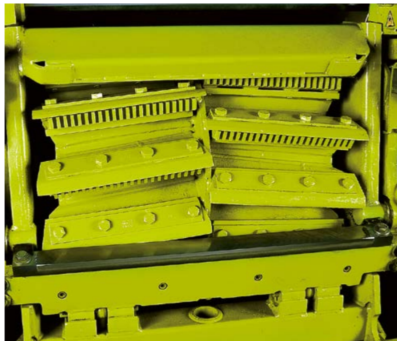
Terien alla olevat mikrovarstat materiaalin lisämurskausta varten
