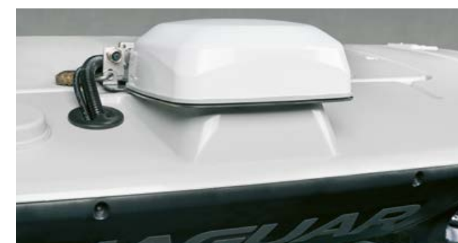
SAT 900 antenni ja vastaanotin yhdessä – varkaudenestojärjestelmällä
