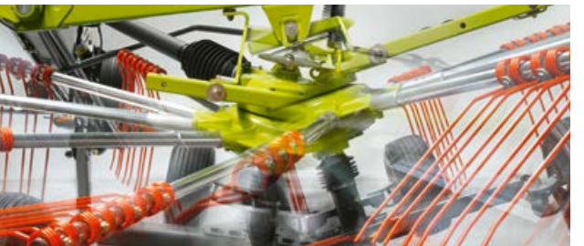
Kardanophængte rotorer: Rotorene tilpasser sig til marken – uafhængigt af traktoren.
