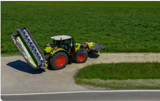
▼ Zelfs de grootste DISCO maakt zich klein: compacte transportpositie ondanks een werkbreedte van 4,20 m.
