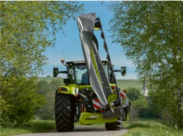
Smalle transportbreedte en vrij zicht naar achteren: in de transportstand van 105° bent u met de DISCO 100 veilig onderweg op de weg. Krachtlijn ontmoet zwaartepunt: de centrale ontlastingsveer brengt de voordelen van de middenophanging optimaal over op zijdelings opgehangen achtermaaiers.
