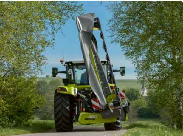
▲ Estrecha anchura de transporte y libre visión hacia atrás: En la posición de transporte de 105°, usted avanza seguro por carretera con la DISCO 100. ▼ Línea de fuerza por el centro de gravedad: El resorte de flotación central transfiere las ventajas del enganche central de forma óptima a las segadoras trasera con enganche lateral.
